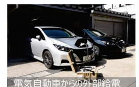
電気自動車からの外部給電
