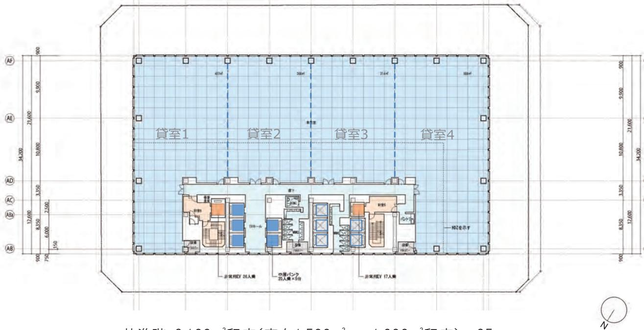
基準階: 2,100m<sup>2</sup>程度(専有1,500m<sup>2</sup> ~ 1,600m<sup>2</sup>程度) × 25フロア
