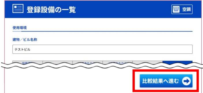
① 「登録設備の一覧」画面で既存設備と導入予定設備が登録されていることを確認し、「比較結果へ進む」をクリック。
