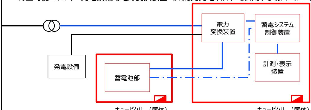
※1 再生可能エネルギー発電設備の電力変換装置と一体型の場合は、蓄電システムに係る部分のみを切り分けること。
