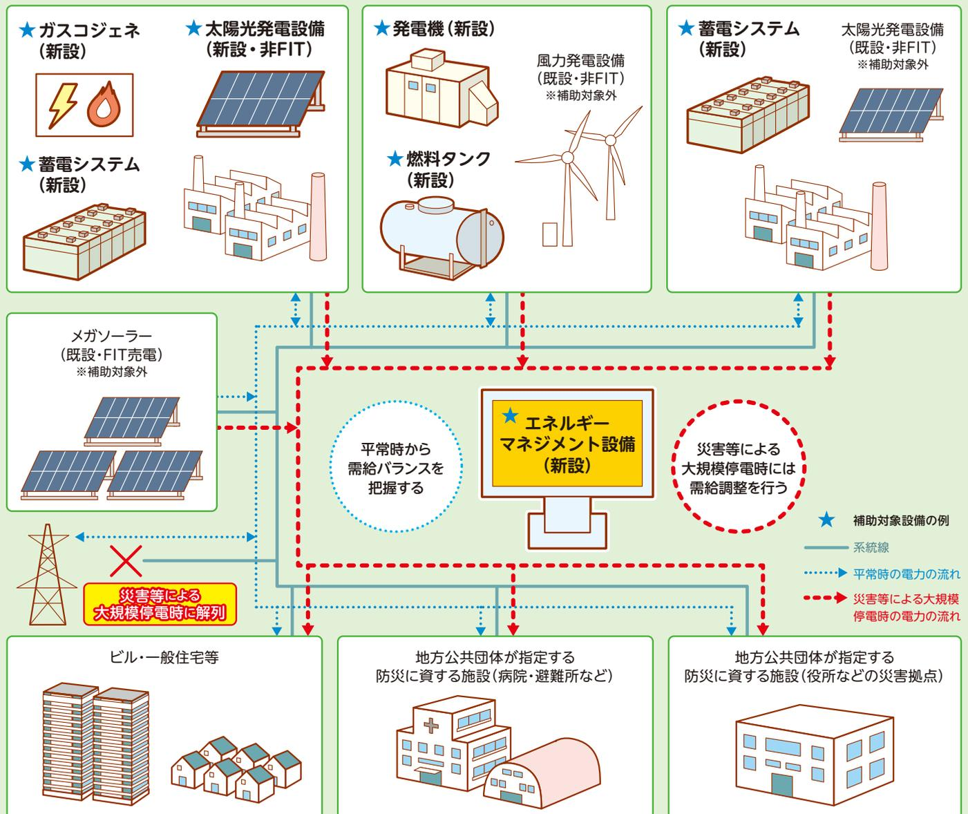
災害等による大規模停電時に系統線より解列し、上記 [ - - - - - ] の電力の流れで自立的運用
