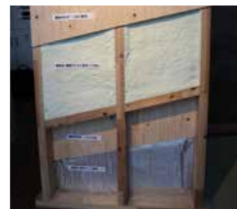
ウレタン遮熱工法
