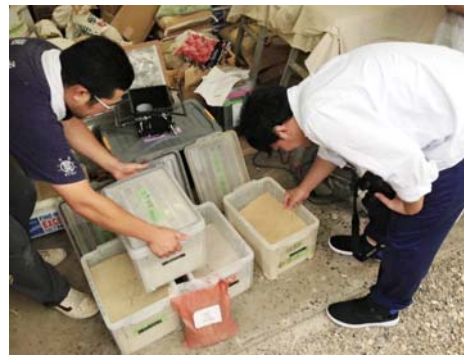
ぬり貫（埼玉県新座市）で、土塗り壁に使う土土の種類と配合を検討。
