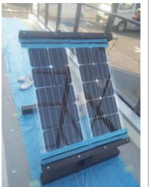
ヒートチャージシステム - 集潜熱蓄熱体による部位毎に最適化された蓄放熱 -
