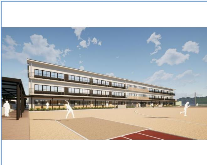
増穂中学校と鰐沢中学校の統合により開校された富士川中学校の新校舎である。「富士町の自然と歴史を未来へつなぐ 共創を生み出す学び舎」をメインコンセプトに掲げ、ゼロカーボンシティ宣言にもとづき、富士川町の2023年に開庁した新庁舎に続く2件目のZEB建築となった。80mの水平ラインを生み出す深い軒、外断熱とLow-E複層ガラスによる高断熱外皮、井水を利用した空調システム、太陽光発電や井戸水利用状況の見える化などにより、生徒自らが環境を学ぶ機会を創出し、環境教育の一端を担う学び舎づくりを目指している。
