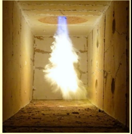
タンディッシュ予熱専用拡散燃焼式酸素バーナ
