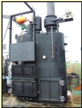
EGボイラー
