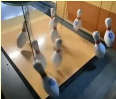
倒れたピンは紐の伸縮で制御され、吊り上げられる。
