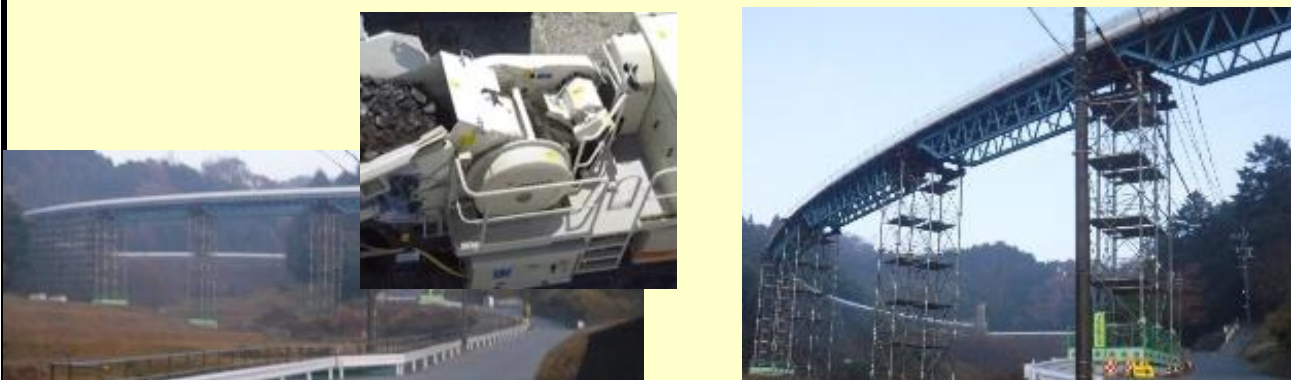
図6 A社納入、稼働中の電動破砕機、フリーラインコンベヤ写真
