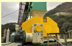
図2 HPGR実機外観
