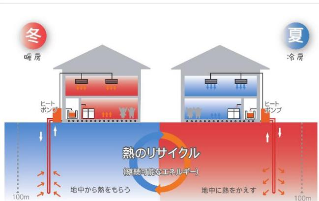
ヒートポンプによって、地中から熱をもらうことにより室内を暖めます。      ヒートポンプによって、室内の熱を地中に かえすことにより室内を冷やします。
