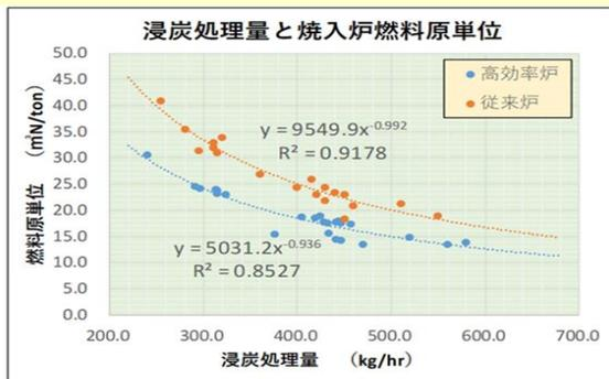
高効率熱処理炉の燃料削減効果
