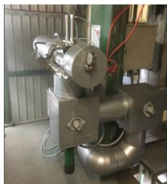
フォームド装置 低炭素アスファルト合材生産可能
