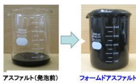
フォームド装置 低炭素アスファルト合材生産可能
