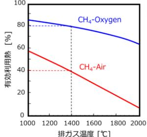
酸素富化燃焼では未反応の窒素が低減
