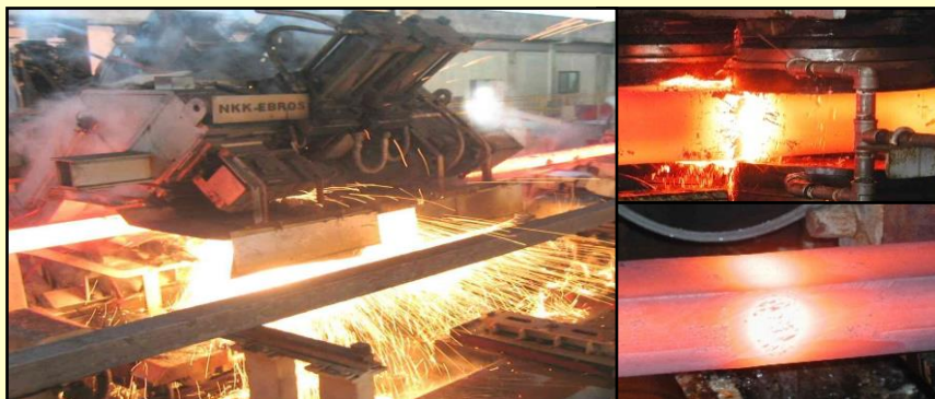
EBROS運転状況（左：Flash溶接，右上：溶接部バリ取り直前，右下：溶接部バリ取り直後）
