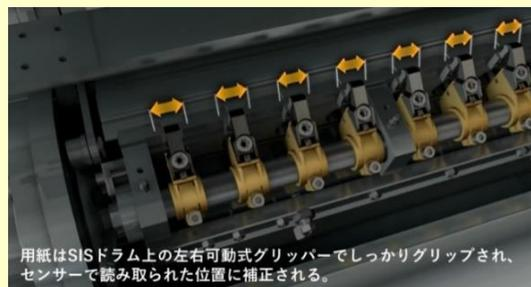
用紙はSISドラム上の左右可動式グリッパーでしっかりグリップされ、センサーで読み取られた位置に補正される。
