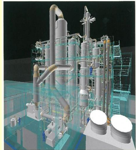
※蒸留塔にMVR技術を適用したハイブリット型の省エネルギー蒸留システム
