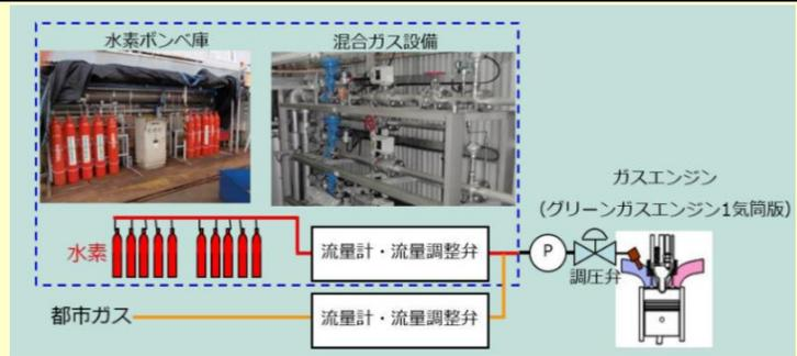
図2 ガスエンジン1気筒分の試験設備
