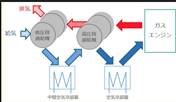
図1 2段過給システム図
