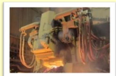
電気炉炉体の排滓口に取り付け密閉度の高いスラグドアとなります。プッシャーで排滓口を清掃し詰まりをなくし、排滓口を常に一定の形状に整えます。
