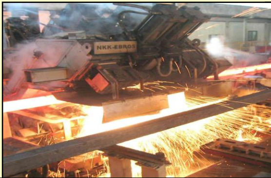
EBROS運転状況 (左: Flash溶接, 右上: 溶接部バリ取り直前, 右下: 溶接部バリ取り直後)
