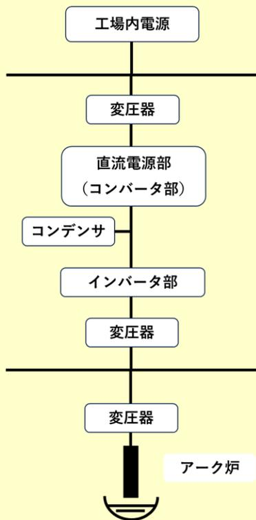
直流電源部（コンバータ部）、インバータ部共にIEGT（世界最大クラスの半導体素子）を採用しており、従来の素子と比較し大容量、高効率で信頼性が向上している。アーク炉へ適用のためスクラップ溶解状況を想定し、インバータ部出力の不均衡状態をシミュレートすることで電圧、電流を安定して制御できることを確認した。これによりスクラップ溶解時に発生していた投入電力の大きな変動が抑えられ、エネルギー原単位の向上、通電時間の短縮を図ることができる。
