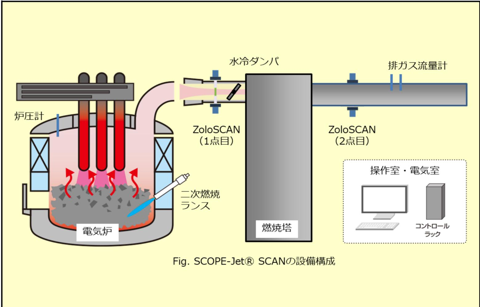
Fig. SCOPE-Jet® SCANの設備構成
