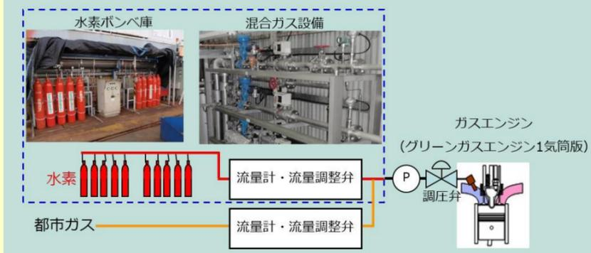
図2 ガスエンジン1気筒分の試験設備
