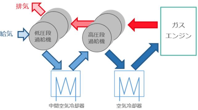
図1 2段過給システム図
