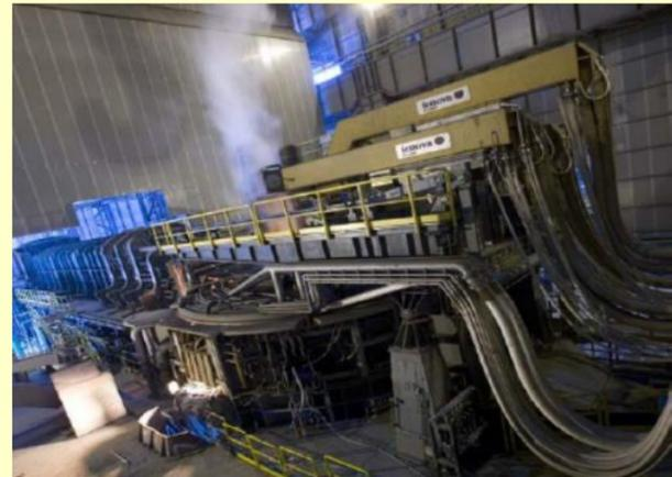
電気炉・予熱コンベア・スクラップ装入コンベア
