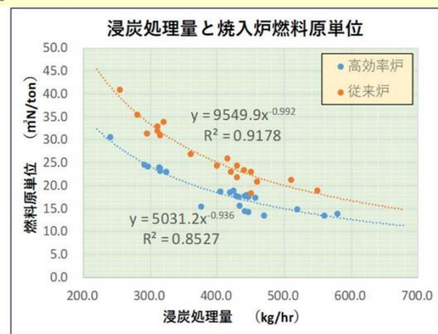
高効率熱処理炉の燃料削減効果
