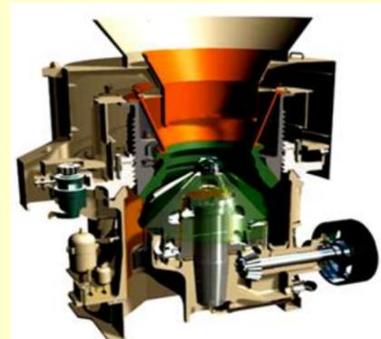
図2 HPコーン断面図
