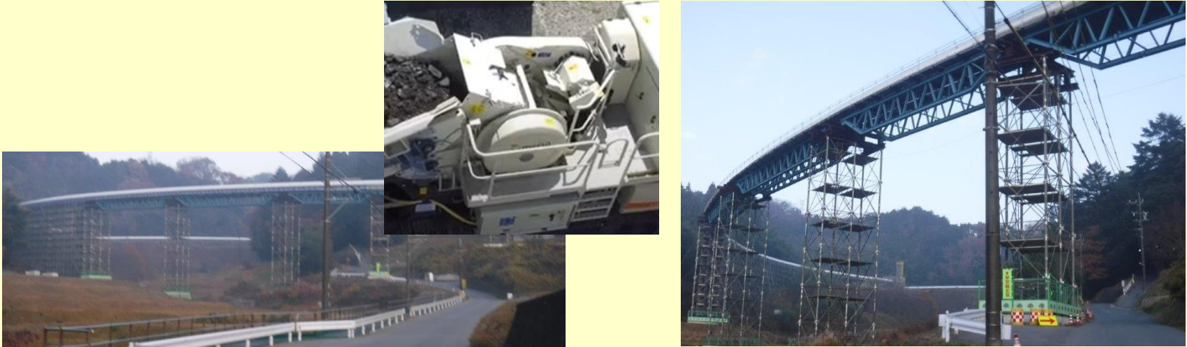
図6 A社納入、稼働中の電動破碎機、フリーラインコンベ
