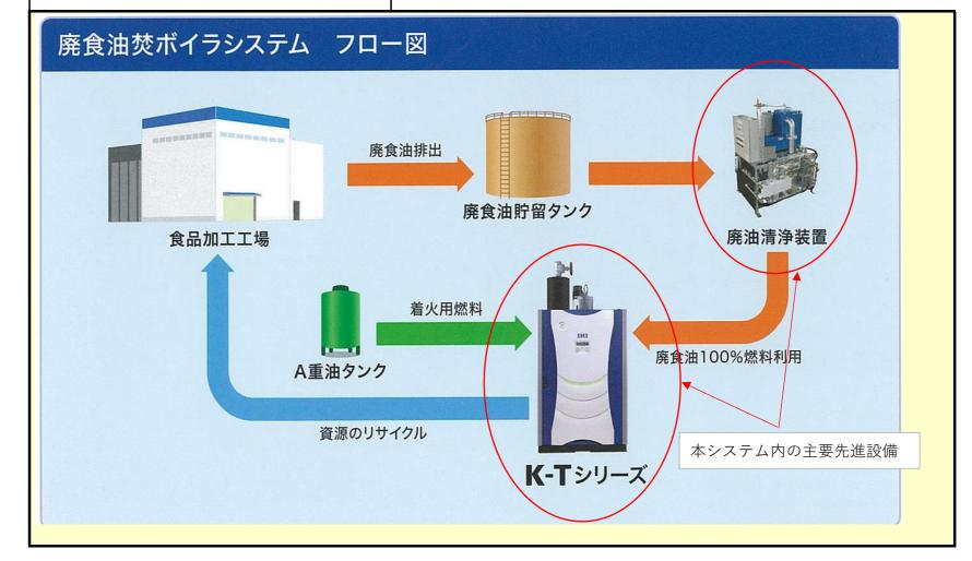
導入事例の概要・イメージ図(\*) 業種・分野 食品製造業 対象設備・プロセス 蒸気ボイラ 【導入イメージ図】 導入実績が無い為、未記入。 ※但し実証実験実施済み。
