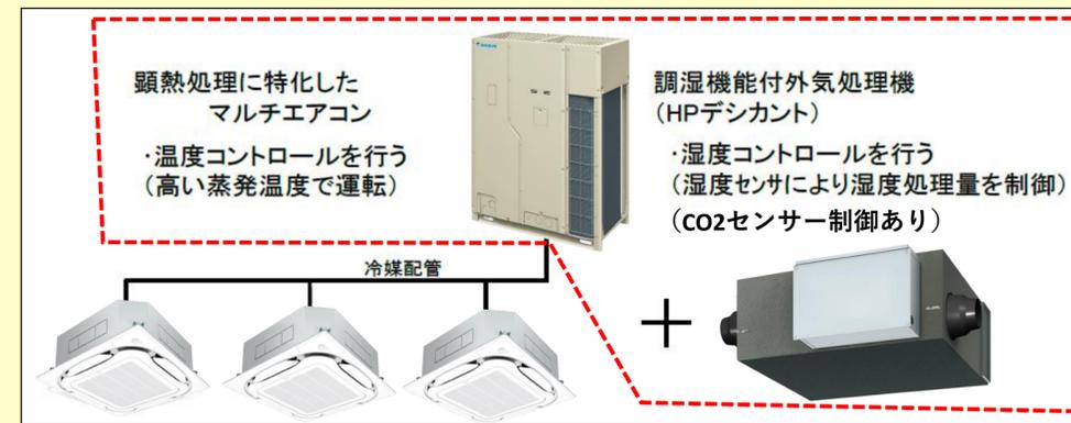
マルチエアコンを用いた潜熱・顕熱分離空調システム
