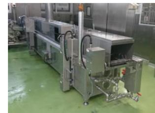
3段式電気式フライヤー5m：1台
