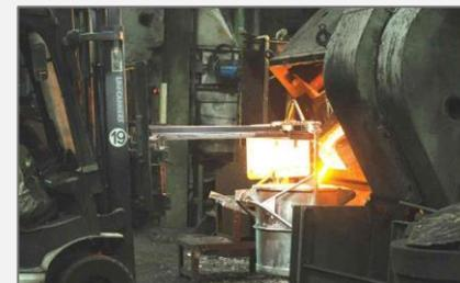
本事業では、溶解工程で使用する「高周波るつぼ形誘導炉」を更新。
