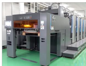
高効率印刷機：1台 出力：16,200枚/時
