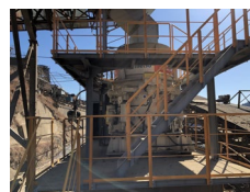
コーンクラッシャー × 1 台 消費電力 350.0kW 処理能力 350-500t/hr
