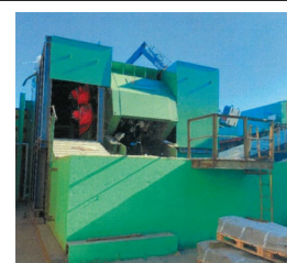
プレシユレッダー 台数：1台 消費電力：382kw 処理量：27.4ton/hr
