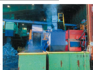
プレシユレッダー 台数：1台 消費電力：382kw 処理量：27.4ton/hr
