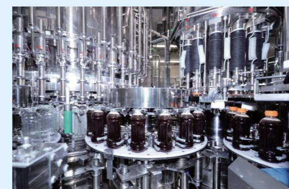
1. 充填工程設備 (ボトル充填機)
