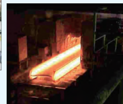
形鋼BDミルの改造(スラブを圧延するために必要な3つの改造) BDミル耐荷重UP +500t BDロールリフト量UP +400mm BDロール胴長 +200mm
