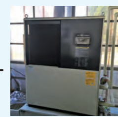
1. 炭化水素洗浄システム洗浄機 1カゴ当たりのC/T約170秒
