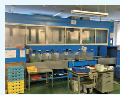
1. 炭化水素洗浄システム洗浄機 1カゴ当たりのC/T約170秒
