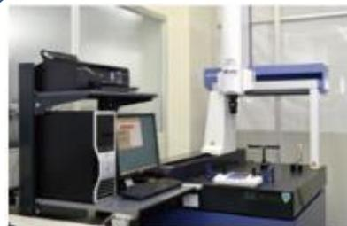
三次元測定機 ミツトヨ Crysta Apex C574
