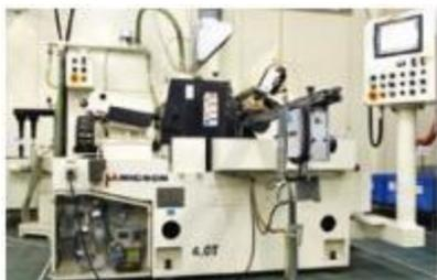
研削盤 ミクロン精密 MPC-450
