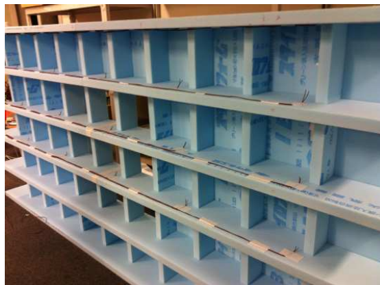
写真 熱電対設置
