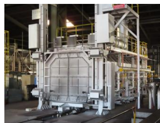
M2台車式 焼入炉 処理能力：15t （平成31年度事業）
