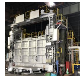
M1台車式 焼鈍炉 処理能力：60t （令和2年度事業）
