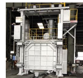
M4台車式 焼入炉 処理能力：15t （令和2年度事業）
