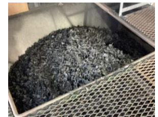
廃タイヤチップ貯留槽 (受入ホッパー)
