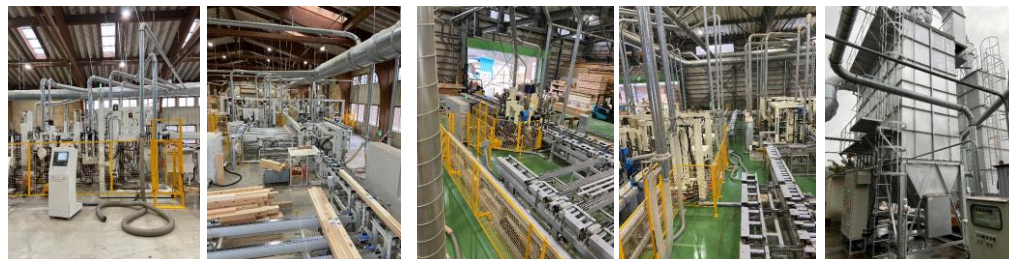
柱縦加工機・横加工機
