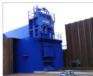
高効率スクラップ切断機 切断能力：1,250t 切断回数：約2.2回/m
