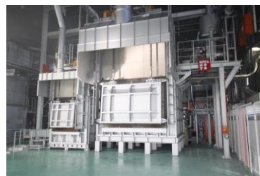
低炭素工業炉：アルミ溶解炉A (DH溶解炉) 溶解能力：2t/h
