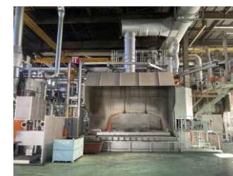
低炭素工業炉：アルミ溶解炉B (CM溶解炉) 溶解能力：3.5t/h
