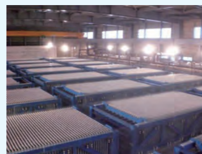
1. 複極式電解槽 イオン交換膜（自社開発の低抵抗膜 Flemion_F8080）
