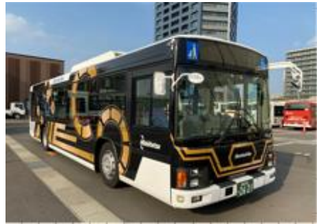
バッテリー搭載容量：105.6kWh
